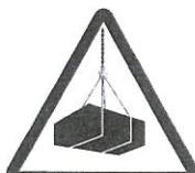
RIESGO CARGAS SUSPENDIDAS
