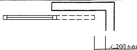
Figura 2.1 Holgura para evitar atrapamientos
